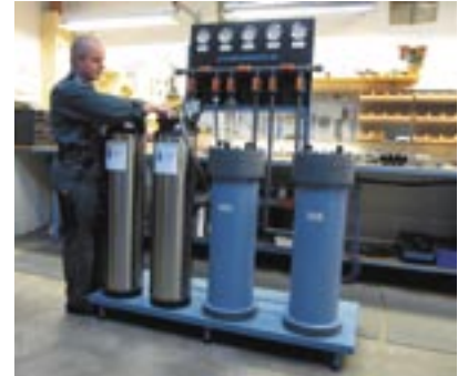
Kompakteinheit mit Beutelfiltern und Mischbettpatronen zur Filtration und Entsalzung von Spülwasser im Kreislauf.
