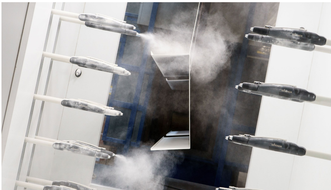
Poedercoating: na een reeks spoelzones wordt het werkstuk afgewerkt met een elektrische lading, die in hoge mate afhankelijk is van de zuiverheid van het water. De juiste waterkwaliteit is essentieel voor het voorbehandelingsproces, ongeacht of het om een e-coat gaat, poedercoating of vloeibare verf.
